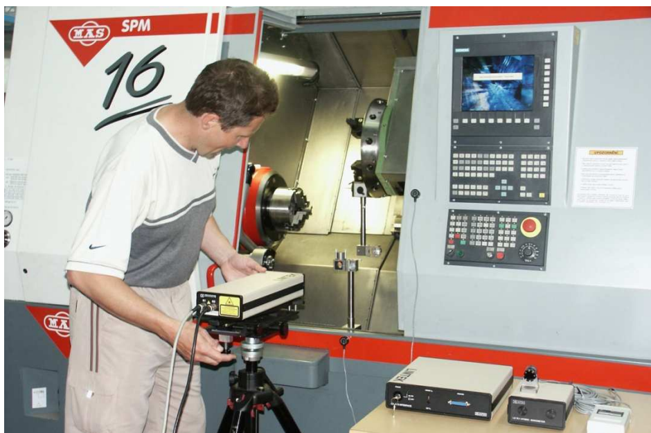
Kalibrace obráběcího stroje laserovým interferometrem Limtek
